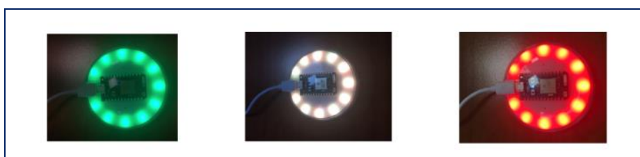
Dispositif lumineux visant l'autorégulation en cours de déploiement au sein des établissements pour les prévenir en temps réel de la situation sonore en provenance de leurs établissements ou de leurs abords
